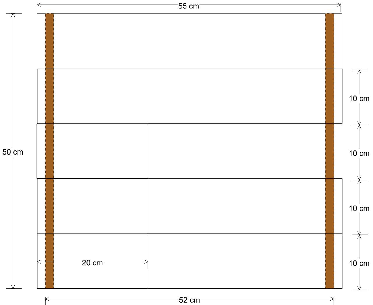
Die beiden Leisten befinden sich links und rechts auf der Unterseite
